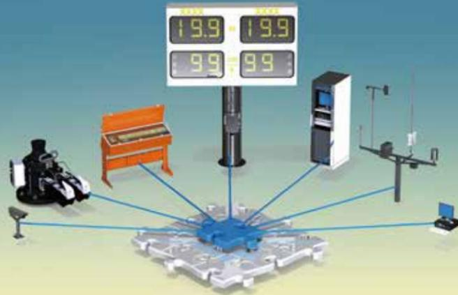
特瑞堡能够将靠泊、系泊及环境系统整合为一套具有逻辑性的、操作方便的综合监控系统。这样，可将关键信息和状态在适当的时间分发给适当的人员，无论是在船上、控制室里，还是在码头上。
