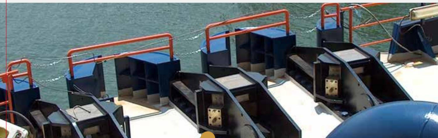
安装在平台上的锚链制动器至1210吨，用于船艏或多点系泊应用（需要载荷下紧急脱放和载荷监测功能时）。
