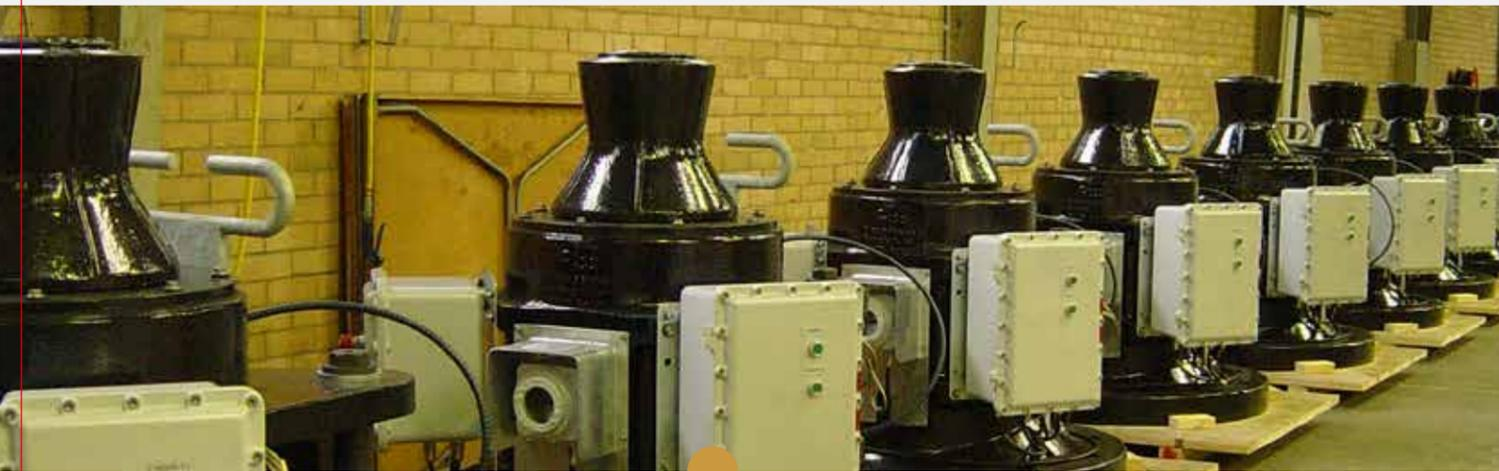
特瑞堡的独立式绞盘为系泊索牵引提供了一种经过现场考验的、安全可靠的方法，减少了对系泊工人手动拉拽的需求。
