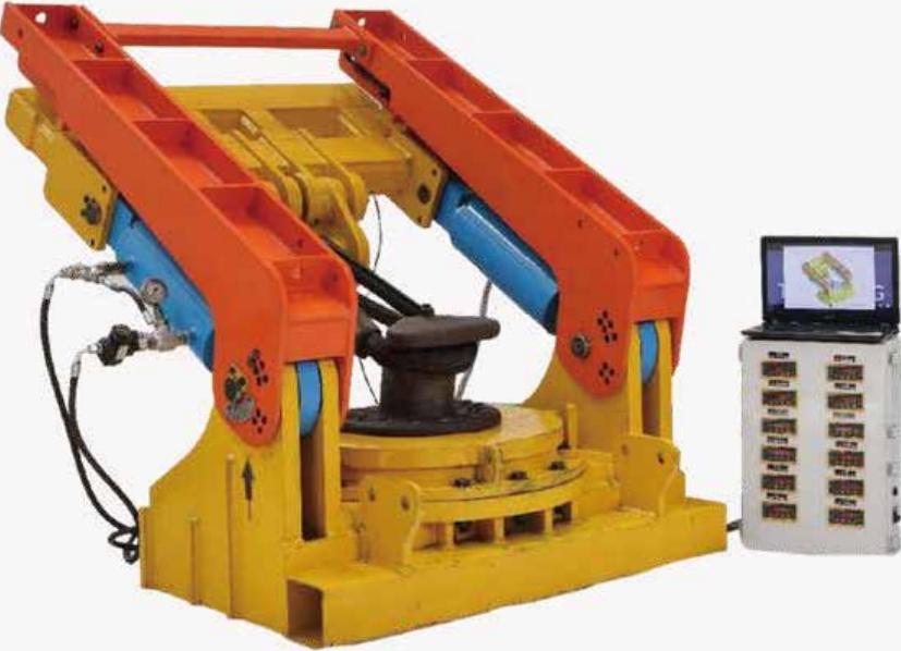
特瑞堡系船柱测试设备
