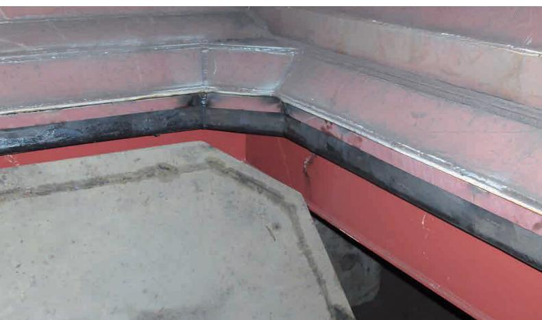
主要用于耙吸式挖泥船底部、泥驳等的泥舱门密封。
